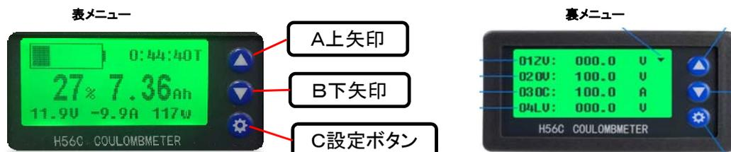
②手動の微調整は上記の裏メニューにて行います。裏メニューはCを短押しにてライト点灯後、直ぐに又Cを3秒の長押しで画面が変更されます。
