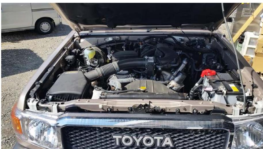
2. 純正のバッテリーを外します (75D31L)
