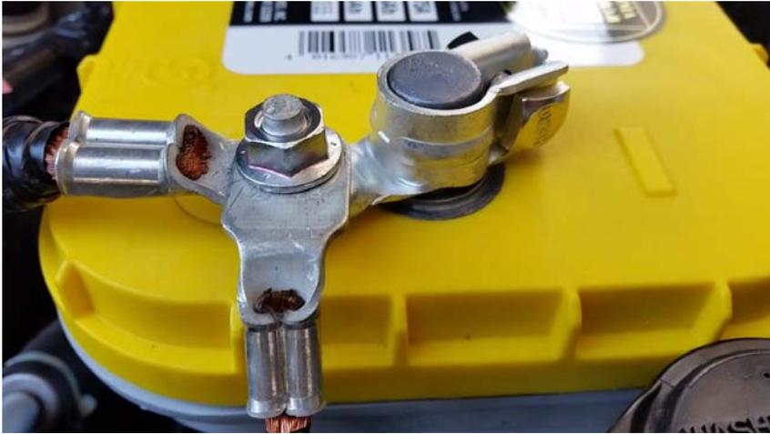
②純正のJボルトの長さが少々短いのでボルト式ロングナット
